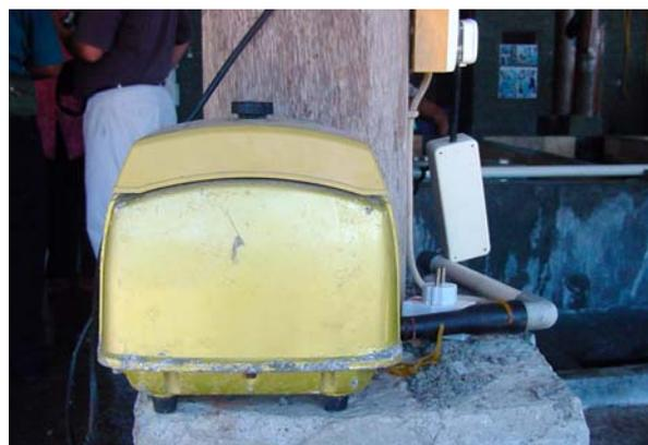
*Blower udara yang berukuran kecil untuk aerasi dalam hatcheri skala kecil*
