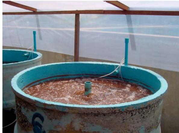
*Tangki beton bundar untuk penetasan Artemia, dengan kapasitas sekitar 500 liter.*
