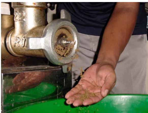
Pakan pellet basah untuk kerapu dapat dibuat sendiri di lokasi budidaya, menggunakan alat penggiling seperti yang ditunjukkan pada gambar ini.
